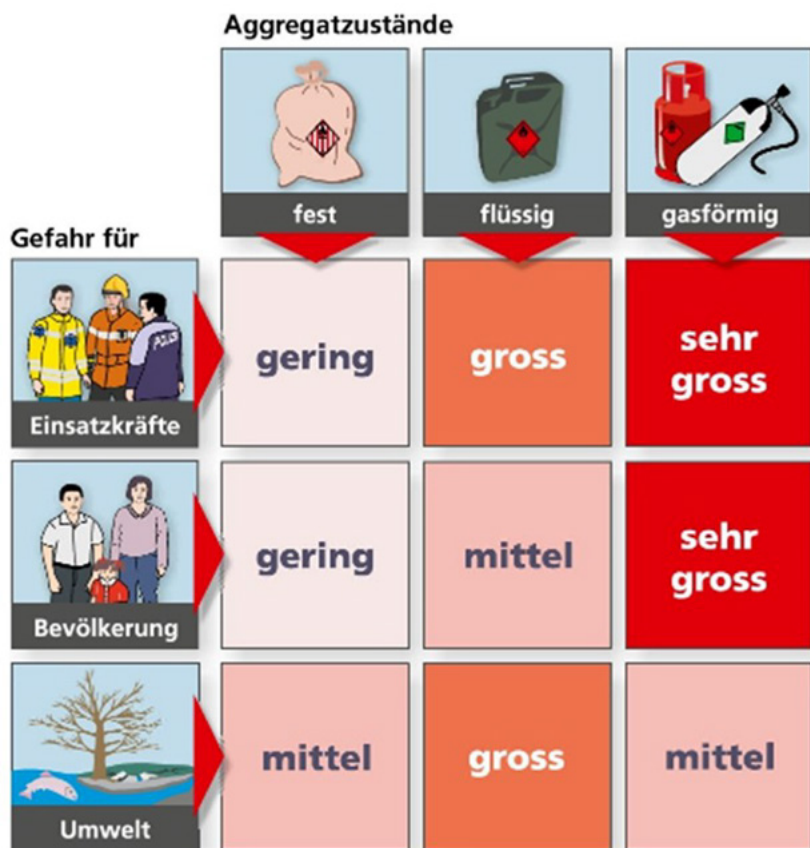
Abb.25: Gefahrenabschätzung bei Chemikalien aufgrund des Aggregatzustandes (FKS)
