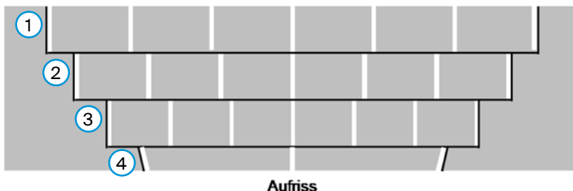
Abb. 61: Stufenschnitt-Technik
