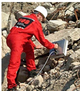
Abb. 42: Beispiel Bio-Radargerät (MEDER)
