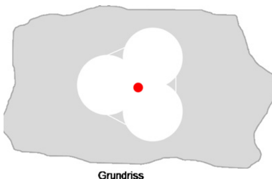
Abb. 62: Erstellen eines einfachen «Mannlochs» mit dem Kernbohrgerät
