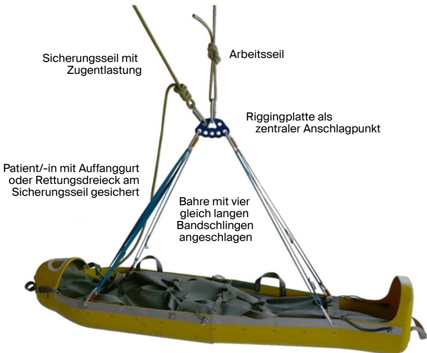
Abb. 68: Anschlagen der Stollenbahre horizontal
